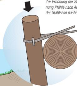
Fixierung Baumstämme/Wurzelstöcke mittels Stahlseilen
