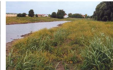
Bild 28 (links) Einseitige Gewässeraufweitung und Uferabflachung (Selz)
